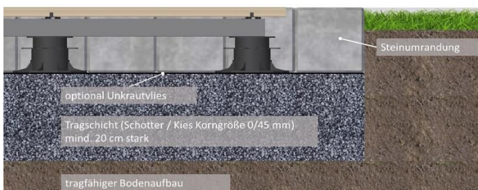
Bild 1. Die Tragschicht sollte je nach Ausführung ca. 15- 20 cm stark sein.
