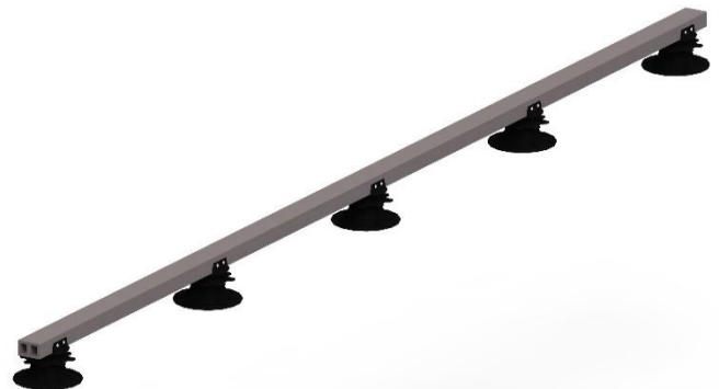
Bild 5. Die Verstellfüße müssen mit einem maximalen Achsabstand von 600 mm an die WPC-Unterkonstruktionen geschraubt werden.
