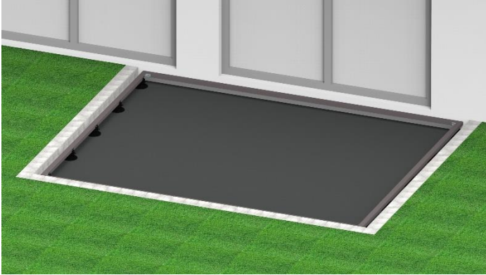
Bild 6. An den 2 äußeren Unterkonstruktionen werden mit Winkeln die vordere und hintere Unterkonstruktion befestigt.
