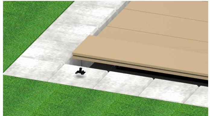
Bild 29. Bevor die letzte WPC-Diele eingesetzt wird, müssen alle Anfangs-/Endclipse auf die WPC-Diele gesteckt werden.
